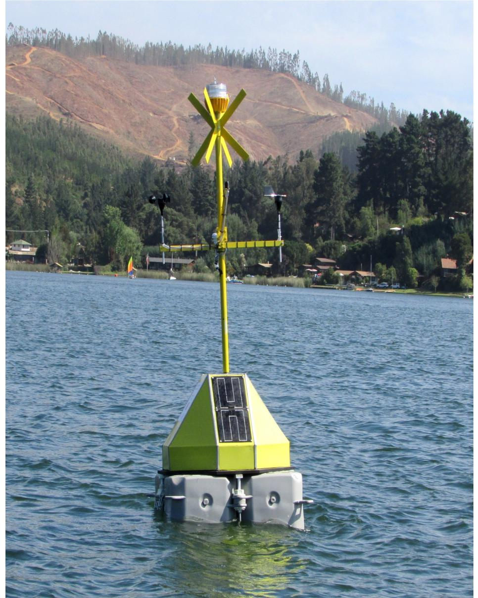
En medio del Lago Vichuquén se instaló una boya telemétrica, la que permitirá monitorear la condición ambiental del sistema hídrico. El instrumento de medición, es parte del proyecto “Red de Monitoreo de la Condición Ambiental de Ecosistemas Acuáticos”, elaborado por el Centro de Ecología Aplicada (CEA), para el Ministerio de Medio Ambiente (MMA), cuyo costo bordeó los 11 millones y medio de pesos.
